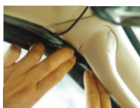
圖④ 配合A柱之橡皮壓條， 可將天線與電源線固 定於A柱內。
